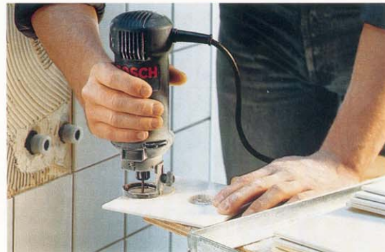
Die absolute Bosch-Neuheit in diesem Jahr: der „Rotocut“. Mit rotierenden Schneidebits lassen sich so beliebige Schnitte in Fliesen, Holzwerkstoffe oder Gipskarton schnell anfertigen.
