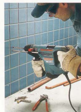
Der 3-Kilo-Bohrhammer „GBH 3-28 E“ bohrte in einem Vergleichstest mehr als 50.000 Löcher mit 14 Millimeter Bohrdurchmesser und 85 Millimeter Tiefe, bevor ein Wechsel des Werkzeughalters erforderlich wurde.
